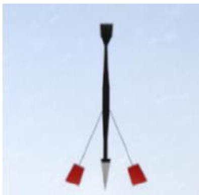
Wird „ vor dem Wind “ genannt. Die Segel sind vollständig ausgebreitet. Das Boot ist langsam. Der Wind fühlt sich ruhig an. Vorwärtsfahren.
