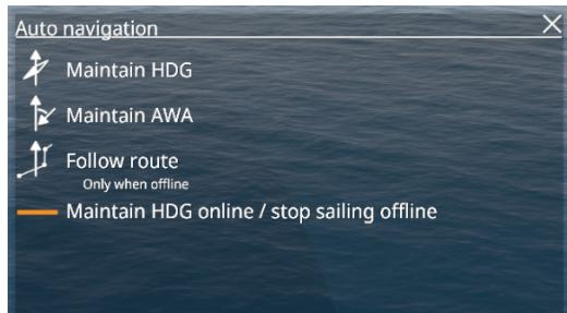
**Первый** вариант позволит лодке двигаться в том же направлении, в котором она плывет сейчас.
